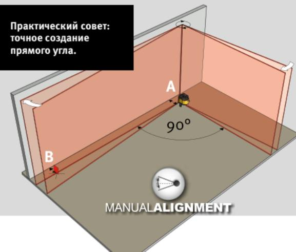
С помощью двух вертикальных лазерных линий прибора LAX 400, образующих прямой угол, можно делать разметку прямых углов в помещениях.
