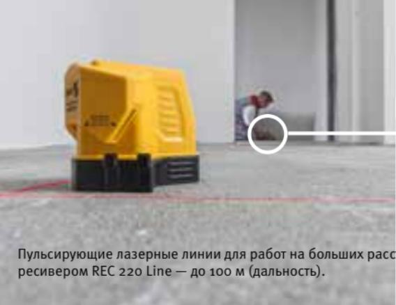
Пульсирующие лазерные линии для работ на больших расстояниях: с линейным ресивером REC 220 Line – до 100 м ( дальность).
