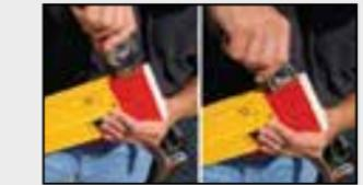
Тип 106 ТМ: специальные накладки закрепляют на пластиинках верхней измерительной поверхности. Один поворот и они уже надёжно зафиксированы.
