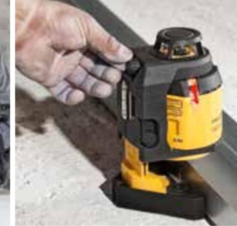
С помощью колесика, расположенного на корпусе прибора, вручную поверните лазер и направьте его на отметку или непосредственно на U-образный металлический профиль для сухой штукатурки и отметьте прямой угол.
